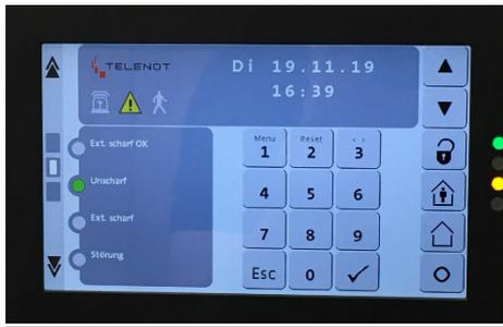
An dieser Anzeige ist die LED „Ext. Scharf OK“ nicht grün. Prüfen Sie alle überwachten Türen und Fenster etc. auf Verschluss.
