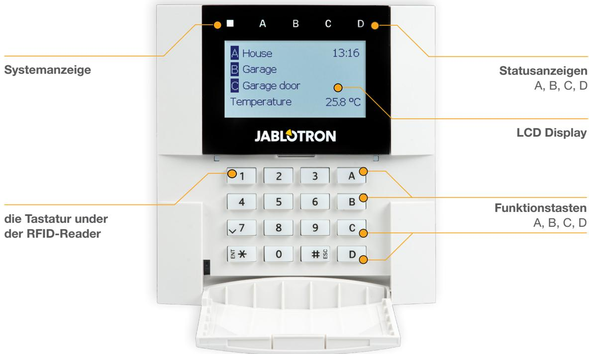
Der Status der einzelnen Bereiche wird von den Statusanzeigen A, B, C, D über dem LCD-Display und den Funktionstasten angezeigt. Die Zentrale kann direkt über die Funktionstasten auf dem Bedienteil bedient werden (Scharf- oder Unscharfschalten des Alarmsystems und andere Automatisierungsfunktionen). Die Funktionstasten und die Statusanzeigen A, B, C, D leuchten farbig, um den Bereichsstatus eindeutig anzuzeigen.
