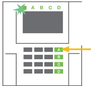
2. Betätigen Sie die Funktionstaste für die Scharfschaltung des gewünschten Bereichs. Es können mehrere Bereiche nacheinander scharfgeschaltet werden. Der zeitliche Abstand bei der Auswahl der Bereiche darf nicht größer als 2 Sekunden sein.
