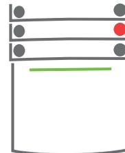
3. Der Befehl wird ausgeführt und das Bedienteil meldet mit einem Ton die Ausgangsverzögerung sofern eingestellt. Der Bereich ist jetzt scharfgeschaltet. Nur Melder mit „verzögerter“ Reaktion lassen Zeit, den überwachten Bereich während der Ausgangsverzögerung zu verlassen. Die Segmenttaste des scharfgeschalteten Bereichs wird rot.
