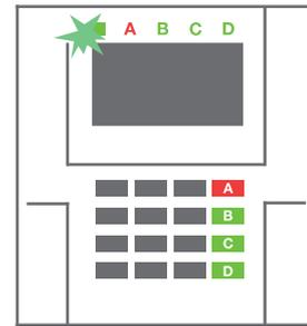
3. Der Befehl wird ausgeführt und das Bedienteil zeigt akustisch die Ausgangsverzögerung an. Der Bereich ist nun scharf geschaltet. Lediglich Melder des Reaktionsmodus „Verzögerter Alarm“ stellen mehr Zeit zum Verlassen des überwachten Bereichs während der Ausgangsverzögerung zur Verfügung. Die Statusanzeige und eine Funktionstaste des scharf geschalteten Bereichs leuchten nun rot.
